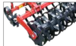
Actiflex ø580 mm - 160 kg/m
